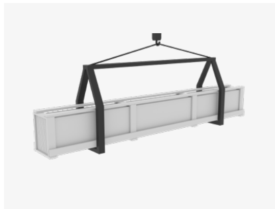
RYS. 5. ROZŁADUNEK PANELI DACHOWYCH
