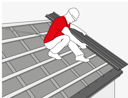
RYS. 16. UKŁADANIE PANELI DACHOWYCH
